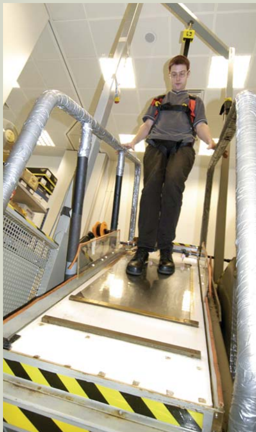
Test pochylni – wyznaczenie klasy śliskości R9-R13
