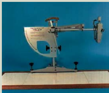
Wahadło do testu śliskości metodą pendulum
