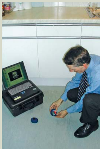
Elektroniczny pomiar chropowatości powierzchni
