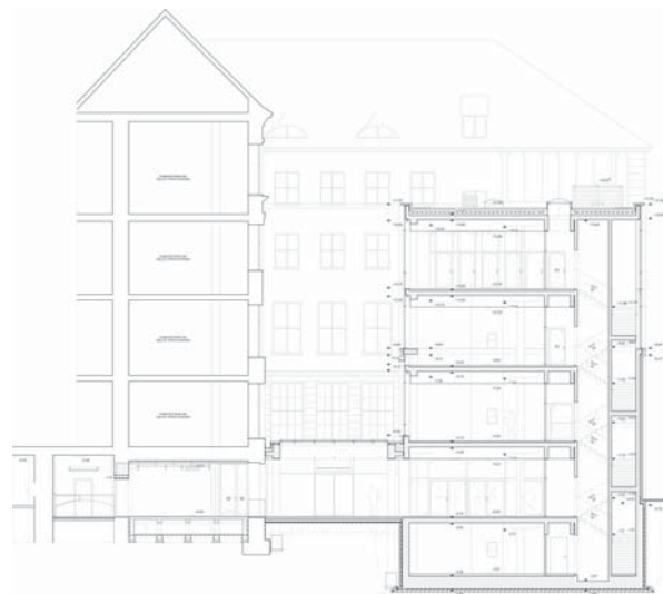
Biblioteka WFPIK UAM w Poznaniu, zabytkowe Collegium Maius zyskało współczesnego towarzysza – użyto tego samego piaskowca, a układem okien nawiązano do rytmu elewacji Collegium
