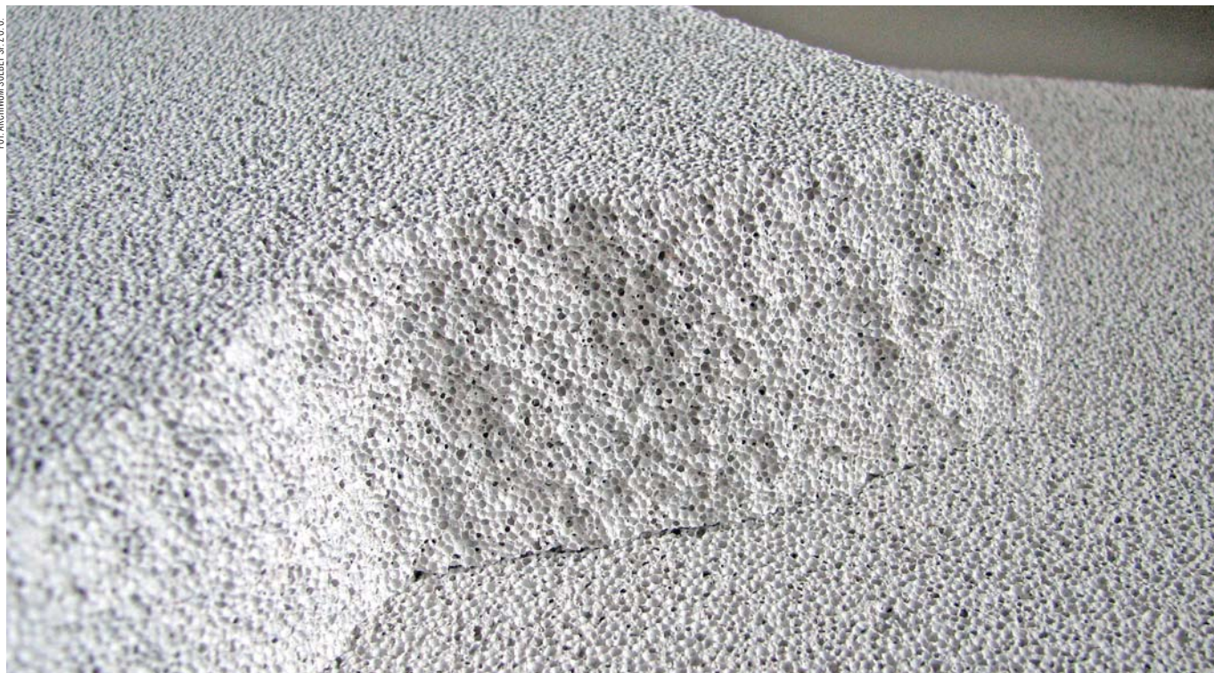
Jednorodna i porowata struktura betonu komórkowego
